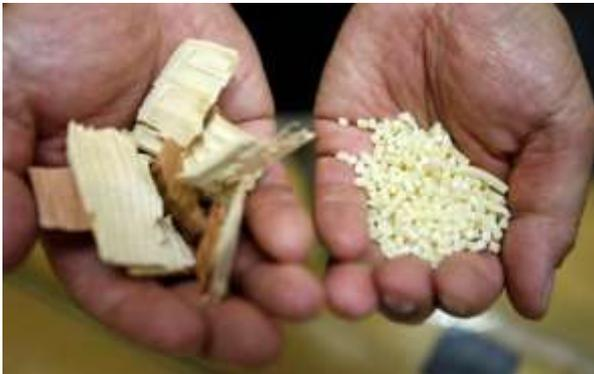
*Fibres de pulpe de bois utilisées pour construire des pièces automobiles, traitées avant d'être converties en cellulose nanofibres. ©Reuters / Naomi Tajitsu*
